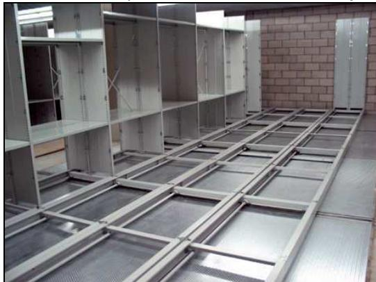
Van unidos por varios patines de chapa AP2 de **3 mm de espesor**, en forma de una omega de 10x70x70x70x10 mm. con las alas dobladas por sus extremos en ángulo recto pero hacia el exterior y provistos de distanciadores transversales en su interior, con unas embuticiones en sus extremos, para albergar los cojinetes soportes de las ruedas. Estos patines van unidos a los largueros por medios de unión amovibles, de modo que la estructura de la plataforma es desmontable y prolongable a voluntad.
